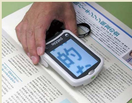
●携帯用の読書拡大機。倍率が選べ、文字の白黒反転も可能
